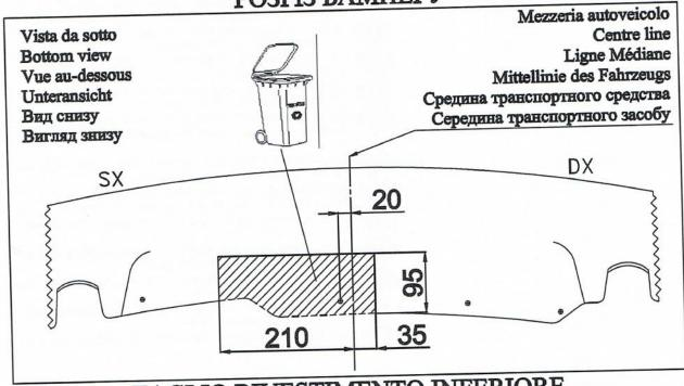
TAGLIO RIVESTIMENTO INFERIORE BUMPER'S LOWER COVERING DÉCOUPE REVÊTEMENT INFÉRIEUR AUSSCHNITT UNTERE VERKLEIDUNG PA3PE3 НИЖНЯЯ ОБШИВКА PO3PI3 НИЖНЯ ОБШИВКА
